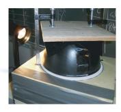
8. Après quelques minutes, un brouillard doit se former sur environ 1 cm dans le fond de la chambre et il est alors possible de voir les traces du rayonnement cosmigue pendant environs 10 min.
